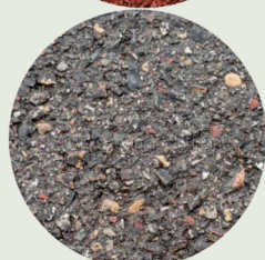
Gebakken klinker mix asfalt in fietspad en rijbanen
